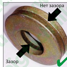
ПРАВИЛЬНАЯ УСТАНОВКА ДИСКОВЫХ ПРУЖИН
