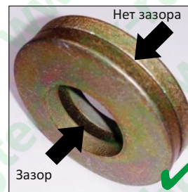
ПРАВИЛЬНАЯ УСТАНОВКА ДИСКОВЫХ ПРУЖИН
