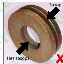
НЕ ПРАВИЛЬНАЯ УСТАНОВКА ДИСКОВЫХ ПРУЖИН
